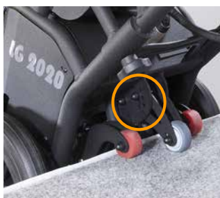
Sistema de braços rotacional, com suporte da roda ajustável em função das diferentes alturas de degrau para aumentar a estabilidade e segurança.
