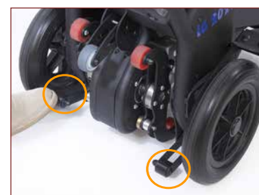
Pedais para elevar as rodas de bloqueio e se mover mais facilmente a cadeira em superfícies planas.
